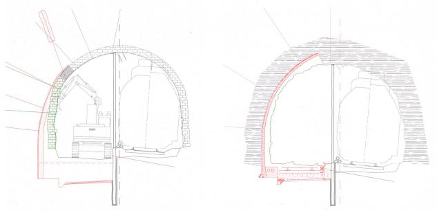
Phase 1: **Vergrösserung** des Tunnelquerschnitts **talseitig** mit den Anpassungen der Sohle im Bexer Abschnitt (links) und der Kalotte im Bereich Saint-Maurice (rechts); das bergseitige Gleis ist während der Arbeiten in Betrieb. Die Schutzwand wirkt in dieser Phase als Bohlwand zur Abstützung des befahrenen Gleises. Zum Abfangen der bleibenden Bruchsteinmauer im Bexer Abschnitt wurde ein Längsträger mit Zugankern eingebaut.
