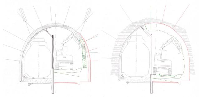
Phase 2: **Vergrösserung** des Tunnelquerschnitts **bergseitig** mit den Anpassungen der Sohle im Bexer Abschnitt (links) und der Kalotte im Bereich Saint-Maurice (rechts); das talseitige Gleis ist während der Arbeiten in Betrieb. Die Schutzwand trägt in dieser Phase zur Stützung im Kalottenbereich bei. Das Abfangen der bleibenden Bruchsteinmauer im Bexer Abschnitt erfolgt ebenfalls mit einem Längsträger.
