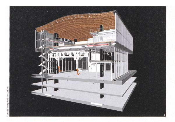
2 Das digitale 3-D-Modell im Querschnitt | The digital 3D model in cross section
