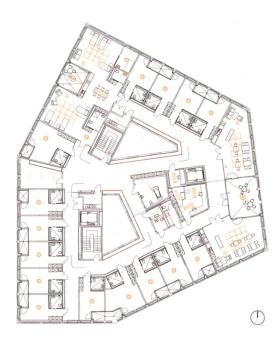
Alterszentrum Appenzell, Grundriss 3. OG, Mst. ca. 1:750 mit dynamischen Lichtdecken in den Aufenthaltsräumen (rechts), in der Pflegeoase (links) sowie dynamischen Einzelleuchten im Stationszimmer (Mitte).
