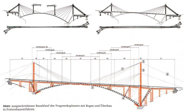
Darunter: umgesetzte Unternehmervariante mit Bogen in Freivorbau und Überbau, konventionell auf einem Traggerüst ausgeführt: ① Haltekabel ② Hilfspylon ③ Traggerüst ④ Freivorbauwagen ⑤ Pylonquerträger ⑥ Rückhaltekabel. Mst. ca. 1:2500.
