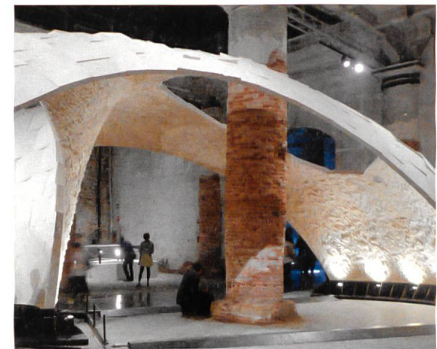
Block, Ochsendorf und Dejong präsentieren eine Schale aus finiten Elementen, die nur auf Druck belastet und materialsparsam sind.
