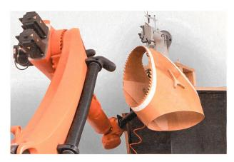
Fertigung der Dachsegmente und ihrer Fingerzinken mit Industrieroboter und -nähmaschine.
