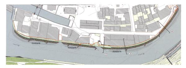
Hochwasserschutzmassnahmen an der Aare, Abschnitt Mattequartier: ① beidseitige Schutzmauern bis Schutzkote, ② linksufrige Schutzmauer (vgl. Plan unten), ③ Schutzmauer auf Höhe HQ100, ④ Schutzmauer bis Schutzkote, — bisherige Uferlinie. Mst. 1:2500.
