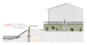
② Linksufrige Schutzmauer Höhe HQ100; Freibord mit mobilem Element bis HQ300 abgesperrt. Querschnitt im Mst. 1: 400.
