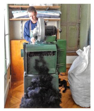
An der Zupfmaschine werden die gedrehten Rosshaarstränge aufgezwirbelt und so für die Füllung vorbereitet. Wird ein ganzer 13-kg-Sack aufgezupft, ist der gesamte Fussboden der Werkstatt mit Rosshaar bedeckt.
