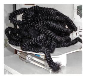
Das gedrehte Schweifhaar wird in Säcken à 13 Kilo geliefert, was für eine 90×200 cm grosse Matratze ausreicht.
