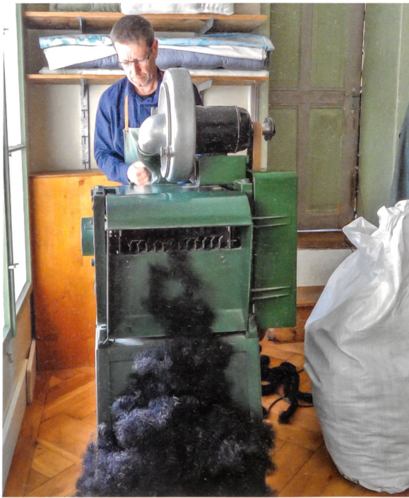
An der Zupfmaschine werden die gedrehten Rosshaarstränge aufgezwickelt und so für die Füllung vorbereitet. Wird ein ganzer 13-kg-Sack aufgezupft, ist der gesamte Fussboden der Werkstatt mit Rosshaar bedeckt.
