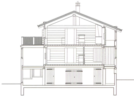
Der Querschnitt zeigt das innen isolierte Haupthaus und die beiden Anbauten. Mst. 1:200.
