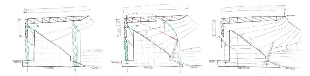
Gleichgewicht eines radialen Fachwerkträgers während des Baus. Grün: Hilfsgerüste, durchgezogene Linien: Auflagerkräfte innerhalb der Fachwerkebene, gestrichelte Linien: Auflagerkräfte ausserhalb der Fachwerkebene, blau: Druckkräfte, rot: Zugkräfte.
