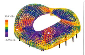
Spannungen im Endzustand infolge ständiger Lasten und Winds: Zug (rot), Druck (lila). Man erkennt den Druckring im Kuppelauge, den Zugring im «Rock» und die zugbeanspruchte Verstrebung an den Stellen, wo die Schalenform am stärksten variiert.
