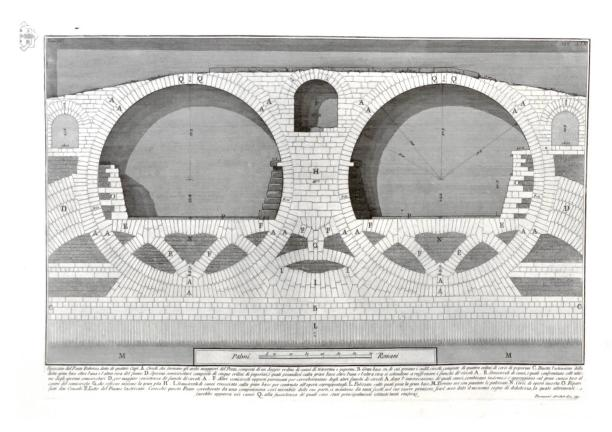
**Die kreisrunden Bögen des Pons Fabricius in Rom** (62 v. Chr) wurden tragwerkstechnisch suboptimal ausgebildet, was unter anderem mit einer entsprechenden Stärke der Bauteile kompensiert wurde. Beim Pavillon sorgen hingegen die vielfältigen Verwerfungen und die externen Zugbänder für die Stabilität der Konstruktion.
