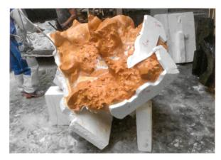
Schalungselement, mittels CNC-Fräse gefertigt.
