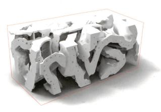
Um die Kosten des 3-D-Drucks zu senken, galt es, das pro Druckvorgang zur Verfügung stehende Volumen optimal auszunutzen. Das Rendering zeigt die Einpassung von möglichst vielen Schalungselementen – das sogenannte Nesting eines Druckraums.
