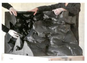
Durch 3-D-Druck hergestelltes Schalungselement.
