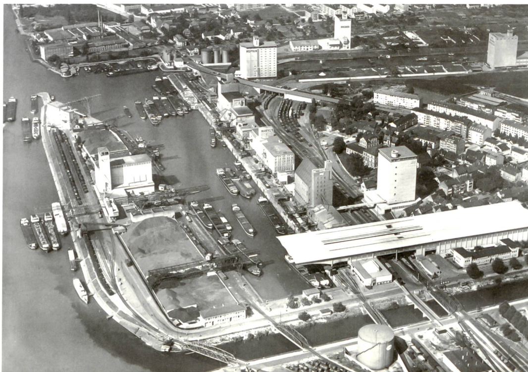
Der Rheinhafen Basel-Kleinhüningen gegen Ende der 1960er-Jahre. Noch sind grosse Kohleberge am Westquai und entlang des Hafenbeckens II aufgehäuft. Gut ersichtlich sind die beeindruckenden Dimensionen (234 m Länge und 50 m Breite) des 1952/53 errichteten Umschlaghofs.
