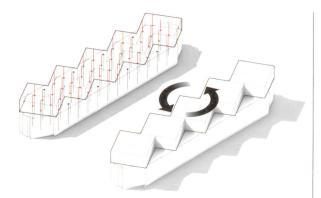
Statisch-räumliches Konzept der Aufstockung: Die Grundrisse sind zugunsten des Tageslichts um 30° gedreht (re.), während der bestehende Stützenraster übernommen wird (links).
