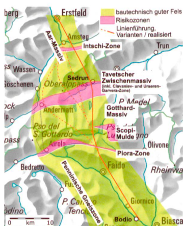
Die Linienführung des Gotthard-Basistunnels berücksichtigt Aspekte von Geologie, Topografie, Stauseen und Bautechnik.
