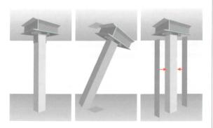
Drei Verfahren zum Einbau eines **nachträglich vorgespannten Stahlpilzes**: Ersatz des Stützenkopfs (links). Ersatz der Stütze (Mitte). Erhalt der Stütze (rechts).
