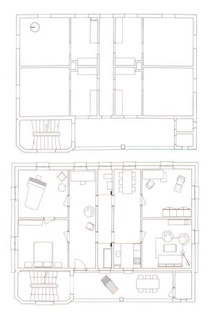
Aus der Enge zur räumlichen Vielfalt: Grundriss nach dem Umbau (oben) und im Bestand (darüber) im  $Mst.\ 1:200.$
