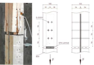
Ganz oben: **Brandeinwirkung** nach ISO-Norm bei gleichzeitiger **Zugbeanspruchung** auf eine Passbolzenverbindung mit GFK-Stegblech. Der experimentelle Brandwiderstand lag mit 55 min über dem rechnerischen Widerstand von 30 min.
