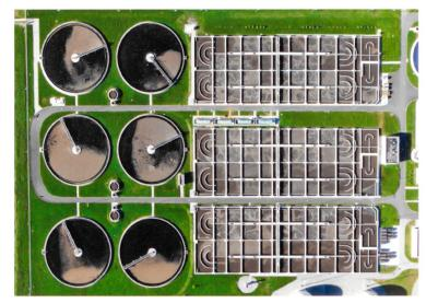
Mechanische, biologische und chemische Verfahren reinigen das Abwasser bislang – zur Elimination von Spurenstoffen braucht es zusätzliche Technik.
