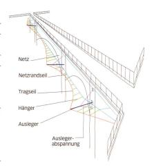
Schematische Netzkonstruktion inklusive Bezeichnung der Tragelemente.
