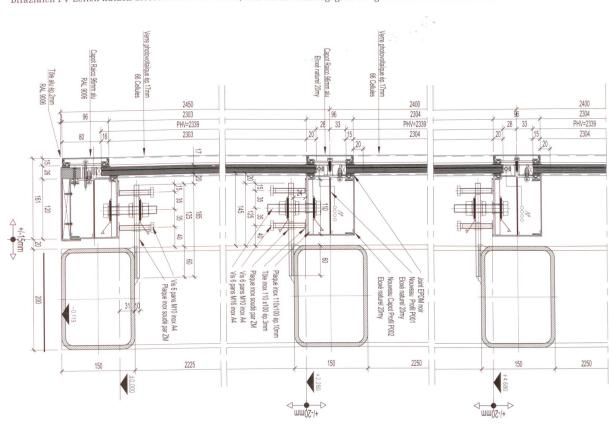
Horizontalschnitt durch die Solarfassade samt Befestigung.
