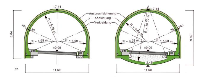
Zusätzliche Baumassnahmen, wie zum Beispiel das Abdichten der Sohle mit Jetting-Säulen oder ein Jetting-Zapfen vor der Ortsbrust, sind bei Bedarf möglich, aber nicht systematisch vorgesehen. Diese Zusatzmassnahmen ermöglichen aber ein flexibles Anpassen an die jeweiligen Bodenverhältnisse und damit einen sicheren Vortrieb. Die Ausbruchsicherung erfolgt mit Gitterträgern, Netzen und Spritzbeton.
