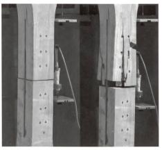
03 Hybridtragwerke GFK/Holz: Ein weiteres Forschungsgebiet der Fachgruppe FVK ist die Entwicklung von ein- und mehrreihigen Stabdübel-, Schraub- und Nagelverbindungen mit Faserverbundkunststoff-Verbindungsplatten für den Holzbau. Eine einfache und effiziente Lösung, um tragfähige Verbindungen im Holzbau herzustellen.
