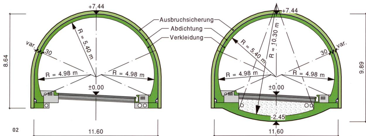
Zusätzliche Baumassnahmen, wie zum Beispiel das Abdichten der Sohle mit Jetting-Säulen oder ein Jetting-Zapfen vor der Ortsbrust, sind bei Bedarf möglich, aber nicht systematisch vorgesehen. Diese Zusatzmassnahmen ermöglichen aber ein flexibles Anpassen an die jeweiligen Bodenverhältnisse und damit einen sicheren Vortrieb. Die Ausbruchsicherung erfolgt mit Gitterträgern, Netzen und Spritzbeton.
