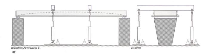
den Holzrippen wird im mittleren Bereich der Spannweite eine Hohlraumdämmung parabelförmig angeordnet. Die Parabelform bewirkt in Feldmitte eine massgebliche Gewichtsreduktion und bildet die Grundform für die Betonschicht. Die Schubkraftübertragung zwischen dem Holzkasten-Zuggurtelement und dem Betondruckbogen wird mit quer liegenden Plattenstreifen im Auflagerbereich gelöst. Die Stirnflanken übertragen dabei die Druckkraft vom Betonbogen auf die Dreischicht-Zuggurtplatte.
