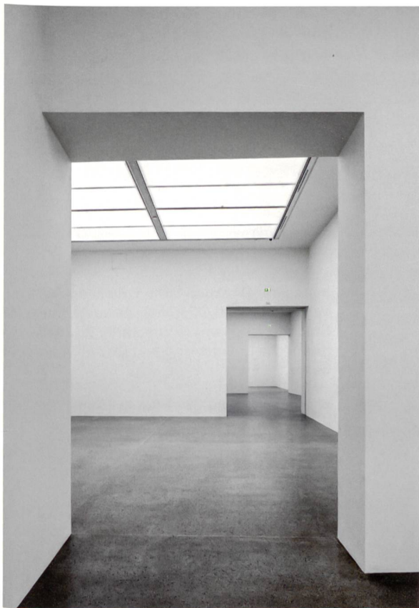
Die «tanzenden Räume» werden durch Wände umfasst, die zwar in einen orthogonalen Grundrissraster eingefügt, jedoch durch den Innenausbau jeweils um ein paar Grad gegeneinander versetzt sind.
