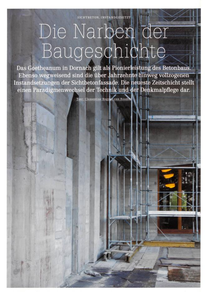
Vorversuche an der originalen Fassadenoberfläche des Goetheanums präzisierten das aktuellste Instandsetzungsverfahren: Die Reprofilierungen sollten sich nicht von Bestand abheben, aber auch nicht völlig kaschiert werden – sie dürfen als Narben in der Sichtbetonfassade erkennbar sein.
