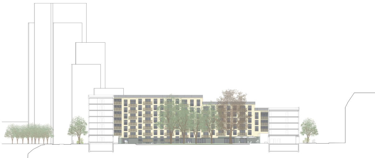
Von der Seebahnstrasse (links) bis zur Erismannstrasse (rechts) nimmt das Gebäude um zwei Stockwerke ab. Im Hintergrund ragen die Wohntürme des Locherguts in die Höhe. Schnitt im Mst. 1:1000.
