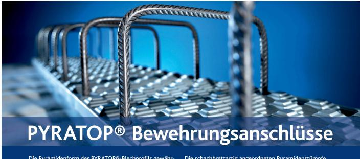
Die Pyramidenform des PYRATOP®-Blechprofils gewährleistet eine biaxiale Schubkraftübertragung quer und längs zur Arbeitsfuge. Zusätzlich zur Haupttragrichtung können Kräfte in sekundärer Richtung, zum Beispiel aus Erdbeben, Wind oder Erddruck, sicher übertragen werden.
