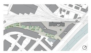
Das **aufgestockte Umschlaggebäude** ① umfassen zwei neue Wohnbauten im Massivbauweise mit 90 Eigentumswohnungen ② und 210 Short- und Longstay-Apartements ③ für «Expats». Das Areal weist eine Ausnutzung von 2.2 auf. Das lange, schmale Dach ④ markiert den S-Bahnhof Giesshübel. Situationsplan im Mst 1:4000.
