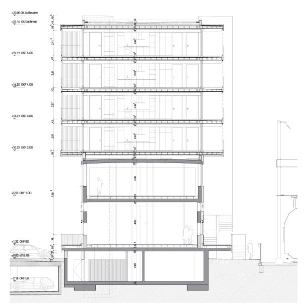
Im Querschnitt zeigen sich die **Strukturen von Sockel und Aufstockung**. Die Stahlbetonkonstruktion des bestehenden Umschlagsgebäudes wies genügend Reserven aus, um den viergeschossigen Holzbau zu tragen.
