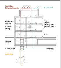
Schema der Energieversorgung. Drei erneuerbare Energieträger versorgen das MFH: Photovoltaik (III), Solarthermie (IIII) und Erdwärme (IIII).
