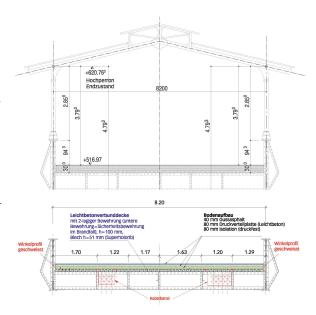
Querschnitt Hochperron (oben) und neuer Bodenaufbau (unten).
