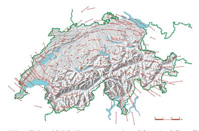
1903 war die Genauigkeit der Distanzmessung geringer als heute. Durch die satellitengestützte Vermessung ergeben sich beim Vergleich **Abweichungen von bis über**2.5 m zwischen Genf und Graubünden, je nach Messstelle auch in unterschiedlicher Himmelsrichtung. Die Karte zeigt diese (fiktiven) Verschiebungsvektoren.
