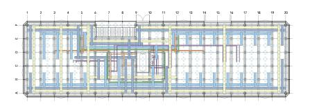
Oben: Installationen in der Decke über EG gemäss dem System Armilla. Mitte: Grundriss Erdgeschoss. Der Eingang und die einläufige Treppe sind entlang der Westfassade angeordnet. Sanitär-, Lift- und Technikzone befinden sich unmittelbar hinter diesem Bereich. Unten: Ansicht Ostfassade.
