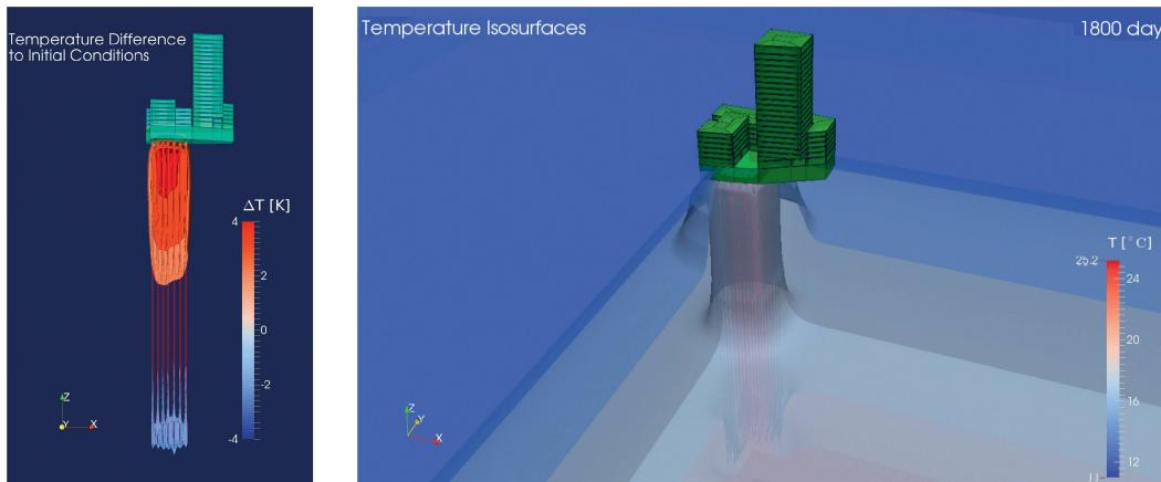
**Links:** Durch den Vergleich der aktuellen Temperaturen mit den Ausgangsbedingungen im Wärmespeicher kann der Speichernutzungsgrad visualisiert werden (hier nach 1800 Tagen Betriebszeit).
