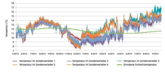
Werte aus dem Monitoring (2013/2014) und den Simulationen zum Anergienetz Suurstoffi: Die Temperaturen im Erdwärmespeicher (grüne Kurve) haben sich aufgrund des zu geringen Wärmeeintrags in das Anergienetz um 1 °C gesenkt (zwischen 5/2013 und 5/2014).
