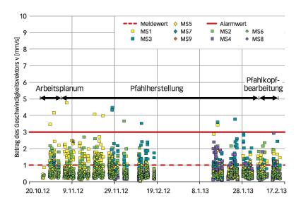
**Die aufgezeichneten Erschütterungen** sind als Betrag des Vektors v der Schwinggeschwindigkeit in Abhängigkeit der Bauzeit aufgetragen. Die Messstellen 1 bis 4 umfassen die Ergebnisse der Geophone im Arbeitsbereich der Pfähle, die Messstellen 5 bis 9 die Messungen in den Produktionsanlagen.
