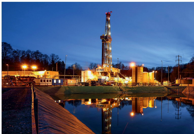
Bohrplatz in St. Gallen: Die Rig 23 der ITAG Tiefbohr GmbH ist eine der wenigen Bohranlagen, die die Anforderungen des Geothermieprojekts erfüllen. Sie verfügt über eine Hakenlast von mehr als 450 Tonnen.
