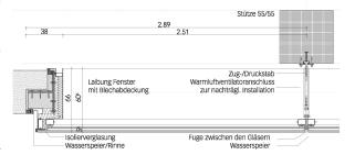
**Druck- bzw. Zugstahlstäbe** – als Pendelstützen zwischen Fenster und Stütze eingebaut – geben Horizontallasten auf die innere Tragkonstruktion ab. Horizontalschnitt im Mst. 1:40.
