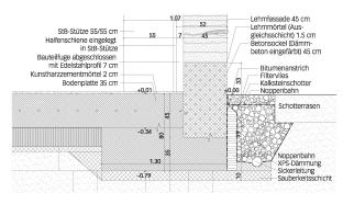
Die Lehmfassade ist stehend, trägt nur ihr Eigengewicht vertikal ab und ist über Halfenschiene und Anker verschieblich mit dem Betonskelett verbunden. Da sie wasserlöslich ist, steht sie auf einem Sockel aus Dämmbeton. Die Tragkonstruktion ist auf Stauwasser (20-jähriges Regenereignis) ausgelegt. Unter dem Dachblech kann der schwindende Lehm frei schrumpfen. Fassadenschnitt im Mst. 1:40.
