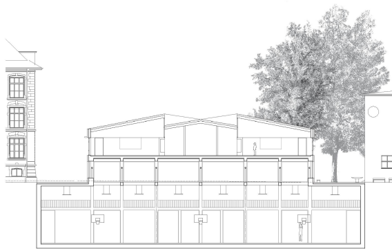
Einheit von Raum und Struktur: Für Turnhalle und Obergeschoss entwickelt das Team im Siegerprojekt je ein passendes Tragwerk. Schnitt, Grundriss Obergeschoss im Mst. 1:600.
