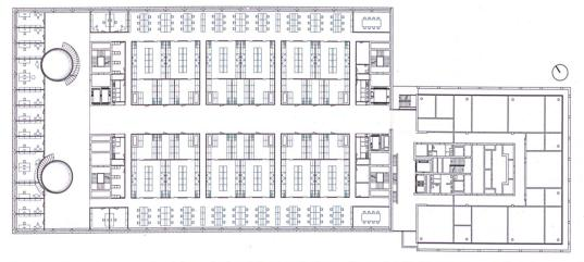
Die Grundrisse sind optimal auf den Laborbetrieb zugeschnitten, die runden Verbindungen zwischen den Geschossen sind ebenso prägnant wie die Auskerbung in der Fassade. Regelgrundriss im Mst. 1:800.
