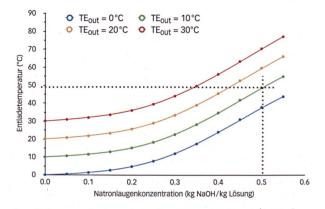
Die Entladetemperatur hängt von der Verdampfungstemperatur (Temperature Evaporator =  $\mathrm{TE}_{\mathrm{out}}$ ) und der Natronlaugenkonzentration ab. Bei einer 50-%-igen Lösung und  $\mathrm{TE}_{\mathrm{out}}$  = 10 °C beträgt die Entladetemperatur 48 °C.
