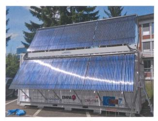
Systemaufbau: Der Prototyp ist in einen Container eingebaut, auf dessen Dach Solarthermiekollektoren montiert sind.
