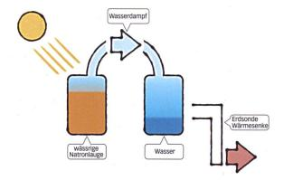
Ladevorgang: Durch solare Wärme wird Wasser aus der wässrigen Natronlauge verdampft. Der Wasserdampf wird wiederum kondensiert und die Wärme dem Erdreich mittels Erdsonde abgegeben.
