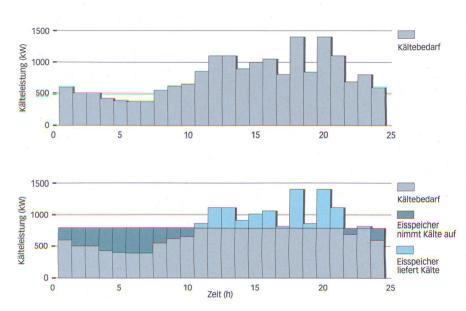
Oben abgebildet ist ein typischer Tagesablauf des Kältebedarfs des Fernkältenetzes in Paris. Dieser stark variierende Bedarf (graue Balken) muss vollständig durch die Kälteanlagen gedeckt werden.
