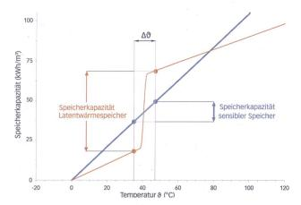
Im betrachteten Temperaturintervall  $\Delta\vartheta$  ist die Speicherkapazität eines Latentwärmespeichers (rot) bis zu fünfmal höher als bei einem sensiblen Warmwasserspeicher (blau).
