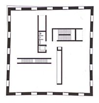
Grundriss Regelgeschoss: Die massiven Aussenwände aus Ziegelsteinen dienen sowohl dem Lastabtrag wie auch als thermische Speichermasse, Mst. 1:500. abschlüsse nehmen im Winter die Wärme der Nutzerinnen und Nutzer wie auch der Geräte auf und geben sie wieder ab. Im Sommer kühlen sie sich in der Nacht ab und senken die Temperatur während des Tages.
