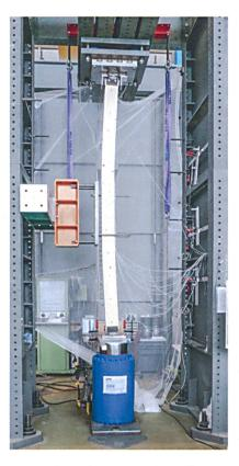
Knickversuche an Brettschichtholz-Stützen an der ETH Zürich
