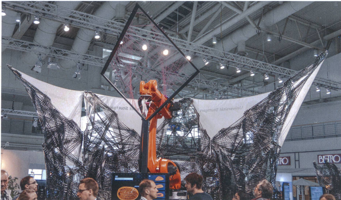
Der Messestand der Universität Stuttgart aus harzgetränkten Carbonfasern an der weltgrößten Industriemesse in Hannover.
