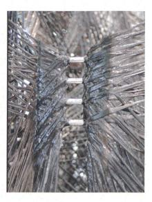
Die Fixpunkte bestehen aus Aluminiumhülsen. Während der Fertigung sind sie mit Bolzen provisorisch stabilisiert, um die Vorspannung in der Carbonfaser aufzunehmen. Später werden die Elemente durch die Hülsen hindurch miteinander verschraubt.
