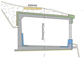
Die geplanten Erhaltungsmassnahmen an der Galerie sind sehr aufwendig. Die nötige Verstärkung des Galeriedachs und der oberen Rahmenecke (grün markiert) ist eine Folge der neuen Lastannahmen. Die Erdarbeiten verteuern die Massnahme zusätzlich.
