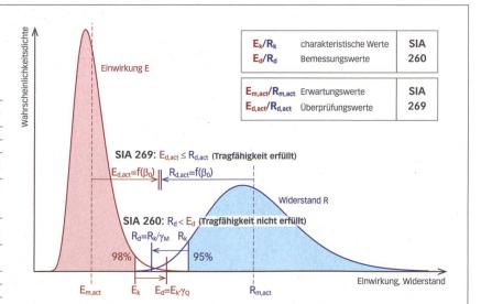
Beim risikobasierten Nachweis der Norm SIA 269 für bestehende Bauten  $\operatorname{werden}$  die Bemessungswerte  $E_{d,\operatorname{act}}$  und  $R_{d,\operatorname{act}}$  in Abhängigkeit vom Zuverlässigkeitsindex  $\beta_0$  ermittelt. Je nach gefordertem Sicherheitsniveau (vgl. Abb. S. 35 oben) kann auf eine Verstärkung des Bauwerks verzichtet werden, obwohl der Nachweis nach den Neubaunormen SIA 260ff. nicht erfüllt ist  $(R_d < E_d)$  (vgl. Diagramm).
