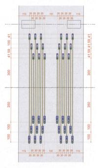
Links: Untersicht der CFK-Lamellen. Rechts: Grundriss der Spannsystems.
