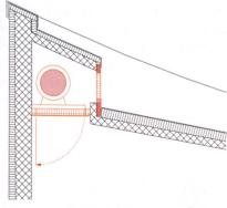
Oben: Detail der Dachauffaltung. Die erforderliche Rauchentlastung wird mit minimaler Auswirkung auf die Gestaltung und ohne Verlust der Bausubstanz integriert. Links: Originalzustand (1978) mit den Auffaltungen am Dachrand, die als Oblichter fungierten.
