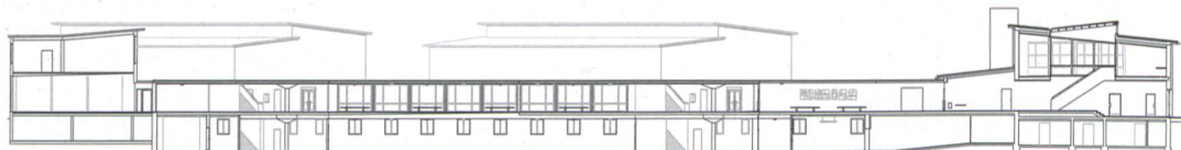
Längsschnitt Trakte A, B und E, Mst. 1:750. Im Hintergrund Klassentrakte C und D.
