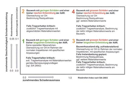
**Schadenausmass und -entwicklung der AAR** können bereits bei der Zustandserfassung definiert werden und dienen als Basis für die Wahl geeigneter Massnahmen.
