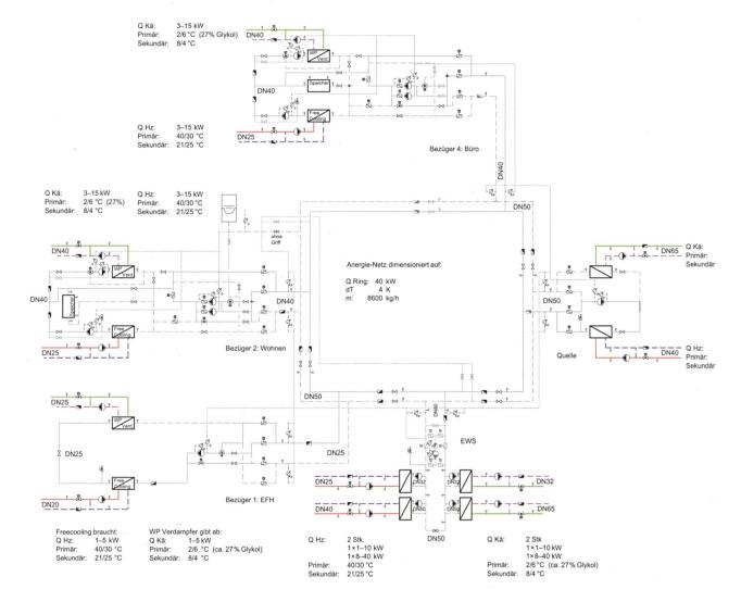
Der Hauptunterschied des NODES-Versuchsstands zu herkömmlichen Netzen besteht im grau abgebildeten Ring (durchgezogene Linie: warm, gestrichelte Linie: kalt), an dem die einzelnen Komponenten angehängt sind: drei Bezüger (z.B. Mehrfamilienhäuser, die heizen und kühlen), eine Quelle (z.B. Grundwasserbrunnen) und ein thermischer Speicher (z.B. Erdwärmespeicher).
