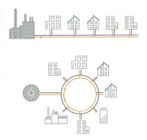
Entwicklung der thermischen Netze: zentral und unidirektional (oben) zu dezentral und bidirektional (unten).
